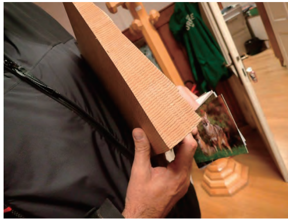
図 3. 4-7 ストラトディバウス用の木。 木目が波打っている。
