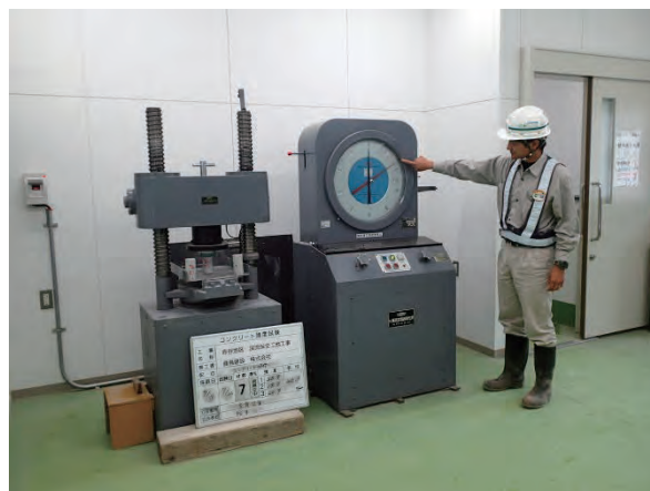
写真 5.36 圧縮強度試験状況
