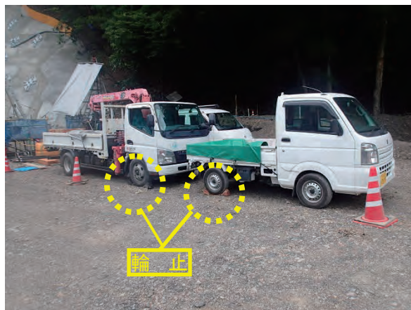
写真 5.28 輪止めの設置
