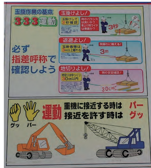
写真 5.9 吊移動及び運転作業要領
