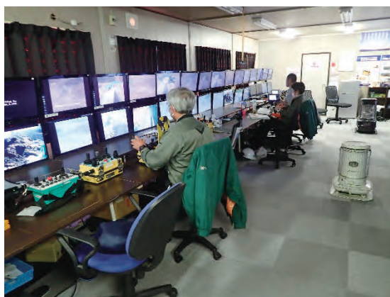
水無川4号堰堤無人化施工操作室
