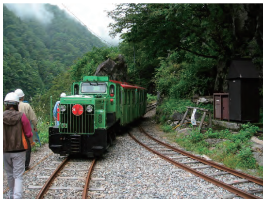
立山砂防工事専用軌道（トロッコ）
