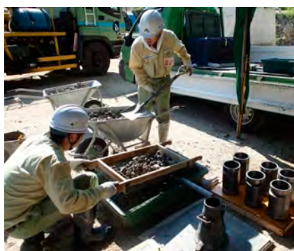
ソイルセメント含水比試験の 篩い分け作業
