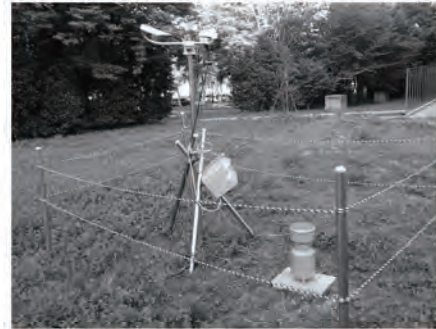
図 1 視程計及び雨量計の設置状況
