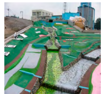
(財)建設技術研究所・ 水理模型実験
